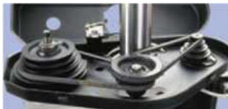
Передача клиновыми ремнями и четырехступенчатыми шкивами
