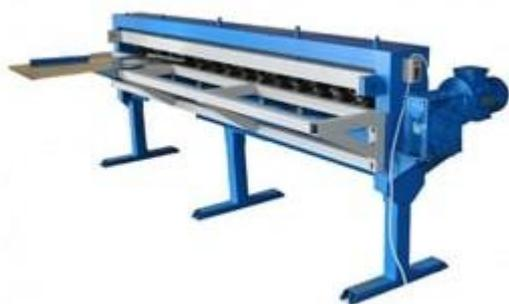
Станок для нанесения ребер жесткости G-2500 используется при производстве прямоугольных воздуховодов. Ребра жесткости придают дополнительную прочность вентиляционным коробам и уменьшают вибрацию воздуховода. Станки отвечают требованиям мобильности и надёжности, предъявляемым современными условиями производства воздуховодов. Z-образные ребра жесткости - уменьшает вибрацию ветканалов при прохождении через них потока воздуха. Трубы диаметром от 2 до 3 дюймов необходимо набивать песком.
