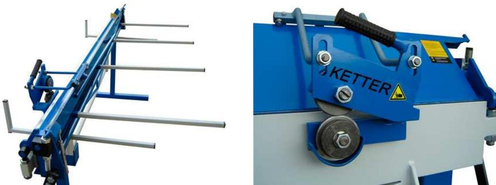
На станке предусмотрена регулировка всех трех балок с помощью тяг. Тяги позволяют регулировать прогиб балок и сабельность.
