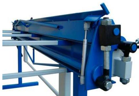
Входящие в комплект столы задней и передней поддержки позволяют быстро и удобно позиционировать лист на станке, раскраивать детали нужного размера. На станке можно совершать гибы с высокой степенью повторения, в комплект входит ограничитель углагиба.
