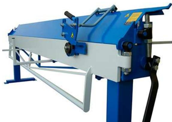
Поворотная балка станка сварена из толстостенных квадратных труб с приваренной на точечную сварку обработанной плитой. К торцам балки приварены уши, в которые установлено устройство регулировки высоты поворотной балки относительно основной. Это же устройство позволяет совершать поворот балки с помощью проверенного временем механизма «вал – втулка».
