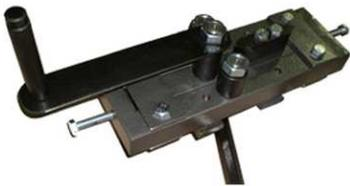
**УЛИТКА.** Инструмент для изготовления завитков типа «Улитка» — на этом инструменте можно изготовить все возможные формы завитка: волюту, завиток, калач. Эти элементы можно сделать с разными радиусами, так как «улитка» состоит из трех секций и можно менять секции по вашему желанию. Можно работать с квадратом и прутком 6 и 8 мм, квадратом 10 и 12 мм. Полоса максимально 30x4 мм.
