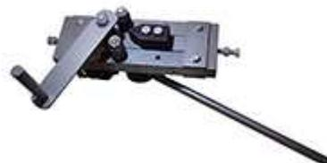
**ТВИСТЕР.** Инструмент для скручивания металла. Можно скручивать полосу, квадрат и несколько прутков. Квадрат максимально 14 мм, полоса – 30x4 мм, проволока до 6 мм (по 3 штуки).
