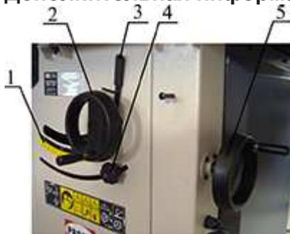
При помощи штурвалов 2 и 5 изменяют высоту и угол наклона пильного диска. Для изменения угла наклона пильного диска ослабьте зажимной болт 4, вращая штурвал 5, ориентируясь по шкале 1, установите пильный диск в необходимое положение, зажмите болт 4. Для изменения высоты выхода пильного диска подымите рукоятку зажима 3 вверх, вращая штурвал 2, установите необходимую высоту выхода пильного диска, опустите рукоятку зажима 3.
