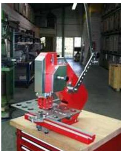
Обычные ручные прессы имеют или очень маленький рабочий ход (но развивают большое усилие) и используются для пробивки или формовки поверхности, или малое усилие при большом рабочем ходе, что позволяет обрабатывать объемные детали. И только MultiPresser позволяет работать в двух режимах – большого усилия или большого рабочего хода.
