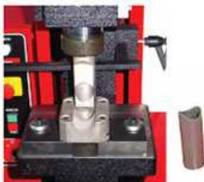
Вырубка труб под сварку
