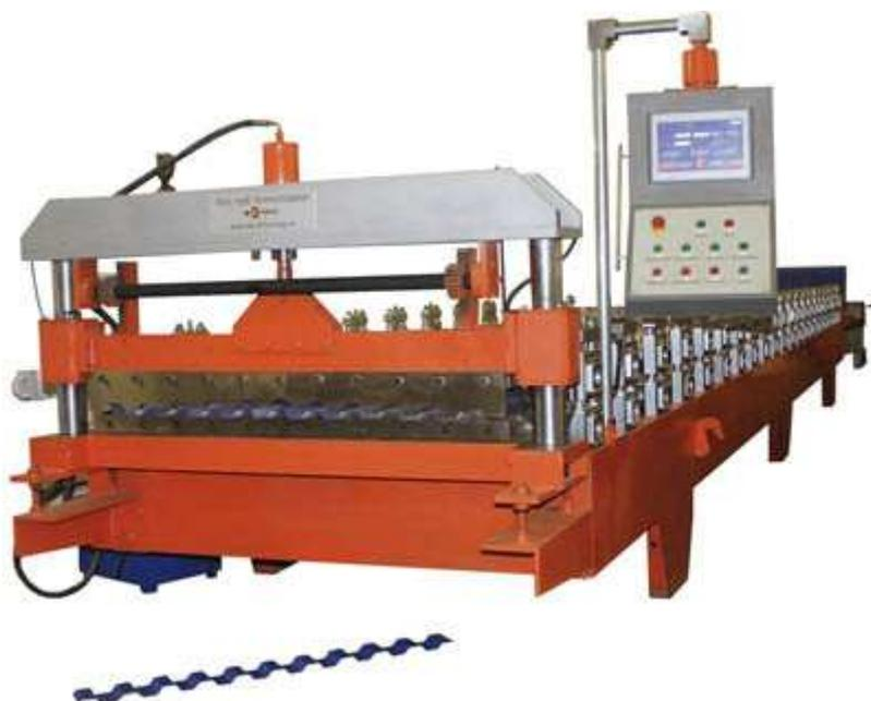
Линии предназначены для производства профнастила: С8, С10, С18(МП20)R, С21 НС 35, С44, НС60, Н75, «Гофра» и многое другое (из рулонного окрашенного и не окрашенного металла).
