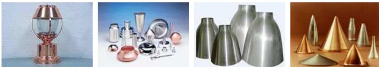
Ротационной вытяжкой полезно изготовлять также хозяйственные принадлежности и аналогичные тонкостенные изделия сложной формы: ковши, кубки, бидоны, чайники, кофейники, котелки, бочонки, круглые детали вентиляторов и вытяжных зонтов, фасонные медные детали пивоваренных установок, барабанов бетономешалок, крупные сосуды и посуду изделия для химической и пищевой промышленности.
