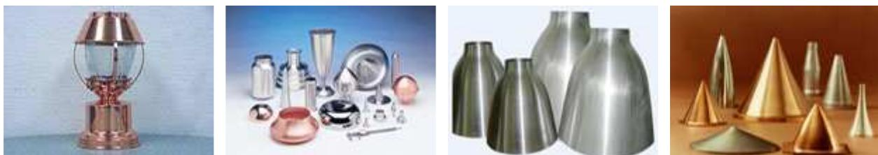
Ротационной вытяжкой полезно изготавливать также хозяйствственные принадлежности и аналогичные тонкостенные изделия сложной формы: ковши, кубки, бидоны, чайники, кофейники, котелки, бочонки, круглые детали вентиляторов и вытяжных зонтов, фасонные медные детали пивоваренных установок, барабанов бетономешалок, крупные сосуды и посуду изделия для химической и пищевой промышленности.
