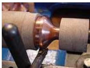
Наиболее распространенным типом инструмента является роликовый инструмент
