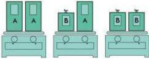
**МОДУЛЬ «А»:** Рабочий процесс с применением абразивной ленты.
