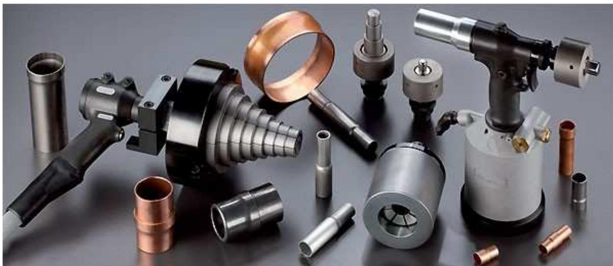
ARTUBE способен обрабатывать трубы диаметром от 6 до 133 мм любых типов материалов: медные и алюминиевые сплавы, конструкционная и нержавеющая сталь.
