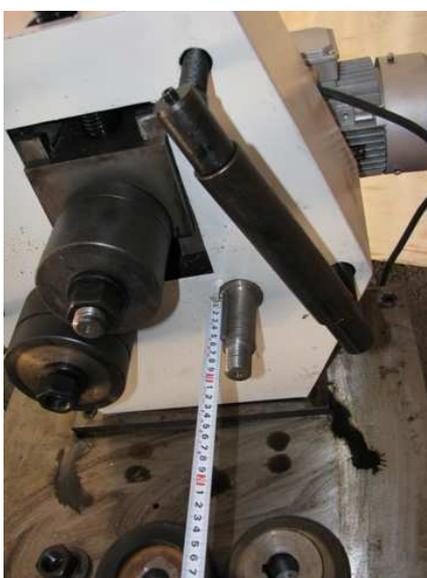
**Комплектация:** стойка управления с двумя ножными педалями; в наборе универсальный комплект оправок (роликов) для изгибания стальных профильных труб до 60x40 мм; профильных трубы из алюминия до 70x70x3 мм; полосы стальной до 60x15 мм.
